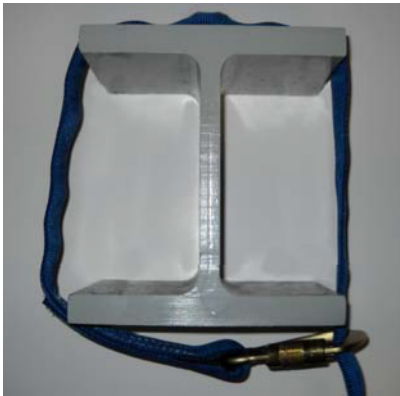
Conexión correcta del amarre
