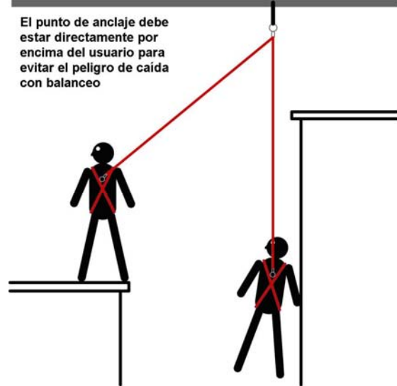
Figura 2.2: Diagrama de caída con balanceo
