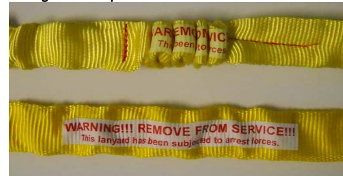
Fig 10.1 - Etiqueta del indicador de SAL Internal
