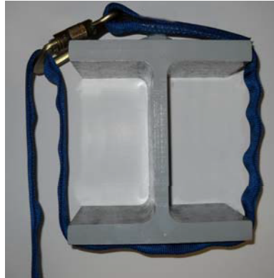
Conexión incorrecta del amarre
