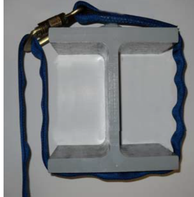
Conexión incorrecta del amarre
