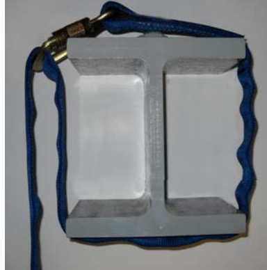
Conexión incorrecta del amarre
