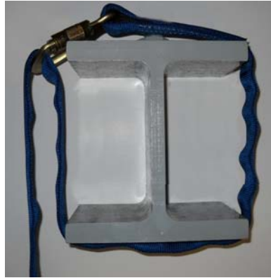
Conexión incorrecta del amarre
