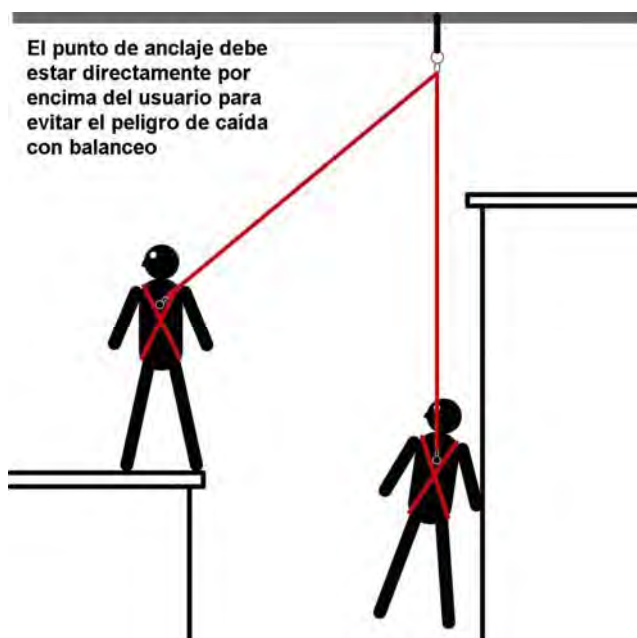
Figura 2.2: Diagrama de caída con balanceo
